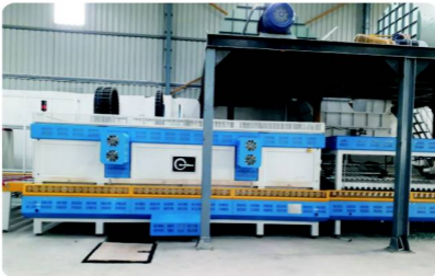
'नार्थ ग्लास' चीन से आयातित होरीजोन्टल टेम्परिंग प्लान्ट का एक चित्र
