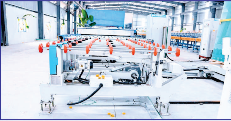
कम्पनी द्वारा आयातित अत्याधुनिक उन्नत तकनीकीयुक्त मिरर लाइन का एक चित्र
